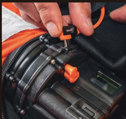
現場での充電が可能な E2 スーパーキャパシターシステム
